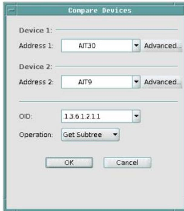
Figura C-22: Ventana de Comparación "SNMP"
